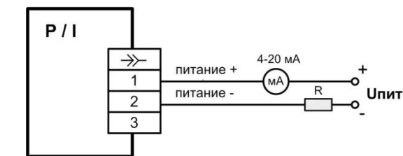
Рисунок Б.1 – Схема подключения датчика для работы (нагрузку R можно подключать как к «+» так и к «-»)
