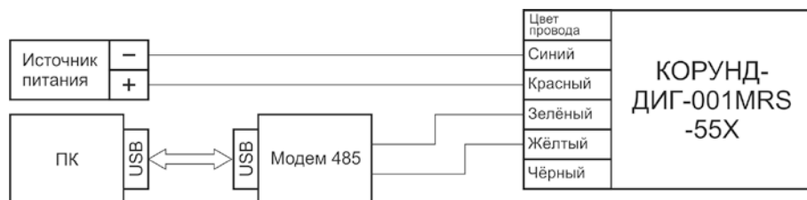
Рис.Б9. Схема соединения датчиков КОРУНД-ДИГ-001МРС-55Х с выходным сигналом RS-485 Modbus RTU в монорежиме
