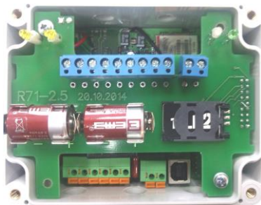
Рисунок 2 – Внешний вид измерителя–регулятора температуры многоканального STR–GSM2–G (при снятой верхней крышке)
