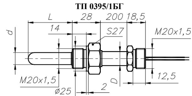
**Рисунок Б.15а** d=8; D=10; L=250, 320, 400
