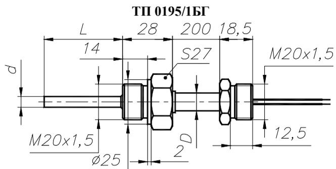
**Рисунок Б.13а** d=6; D=10; L=320...1000
