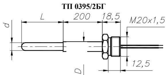
**Рисунок Б.14а** d=8; D=10; L=250, 320, 400
