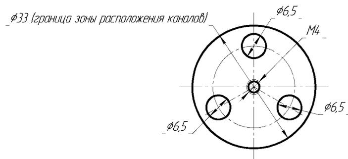
Рисунок А.7 Стандартный набор каналов в блоке сравнения ЭЛЕМЕР-КТ-500/М2.
