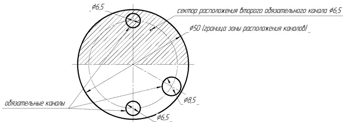
Рисунок А.10 Нестандартный набор каналов в блоке сравнения ЭЛЕМЕР-КТ-500/МЗ.\*
