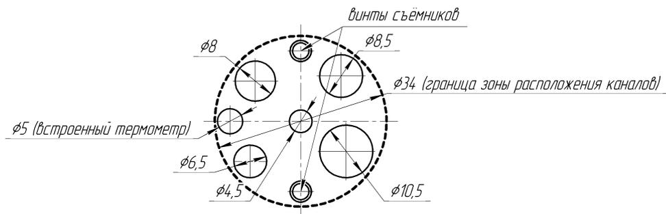
**Рисунок А.1 Стандартный набор каналов в блоке сравнения ЭЛЕМЕР-КТ-900К и ЭЛЕМЕР-КТ-1100К**
