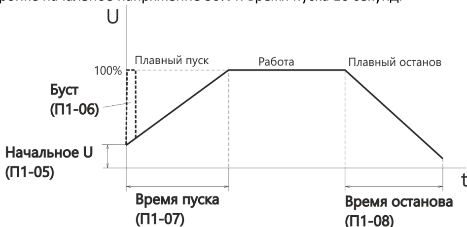
Рисунок 5 – Диаграмма плавного пуска с нарастанием напряжения и плавного останова
