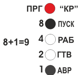
Рисунок 9 - Пример индикации значения уставки =9
