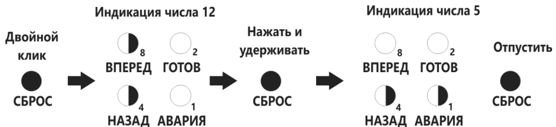
Рисунок 8 Пример индикации тока 125%
