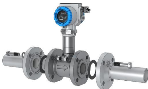
Рисунок 3.12 – Схема монтажа фланцевого расходомера в трубопровод
