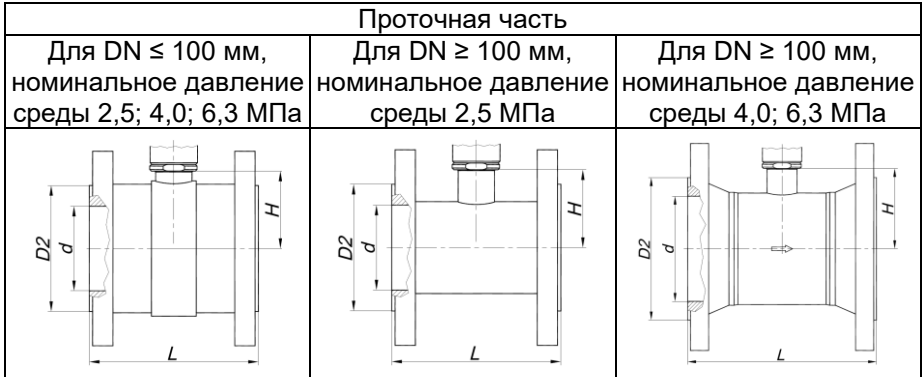
Рисунок Б.10 – Проточная часть расходомера (тип присоединения к процессу «фланцевый»)
