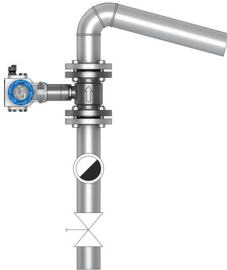
Рисунок 3.16 – Пример допустимого монтажа расходомера в вертикальный трубопровод
