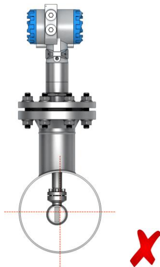
Рисунок 3.22 – Пример неверного монтажа зондового расходомера
