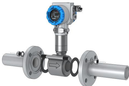
Рисунок 3.13 – Схема монтажа бесфланцевого (сэндвич) расходомера в трубопровод
