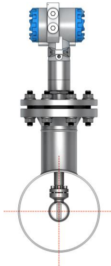
Рисунок 3.21 – Монтаж зондового расходомера
