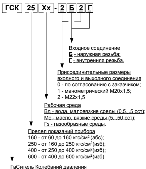
Рисунок 1.1 – Условное обозначение гасителей колебаний давления
