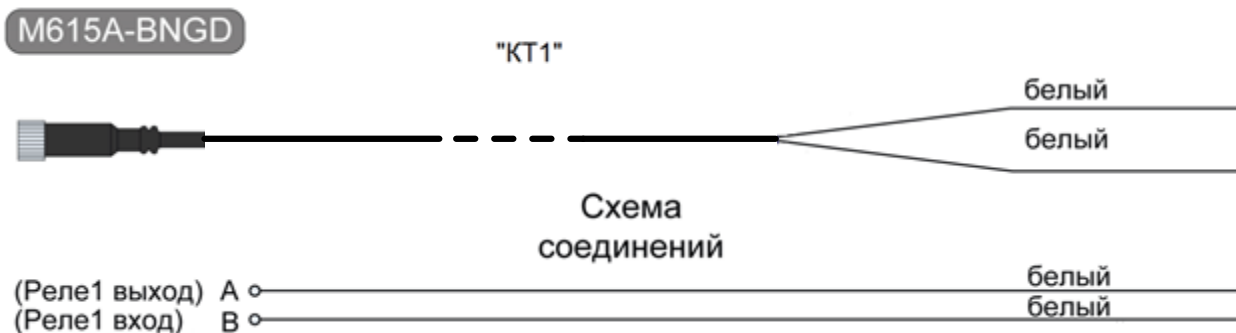
Рисунок А.7 – Соединительный кабель «КТ1» для подключения КДМ к преобразователям давления при тестировании реле
