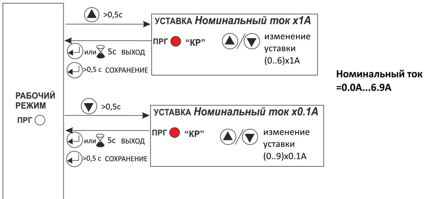
Рисунок 6 –Схема работы режима быстрой настройки
