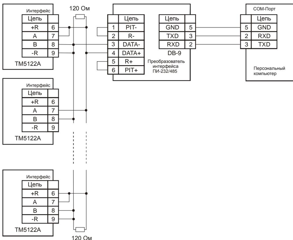
ТМ 5122А,...- измерительные приборы с интерфейсом RS 485.
