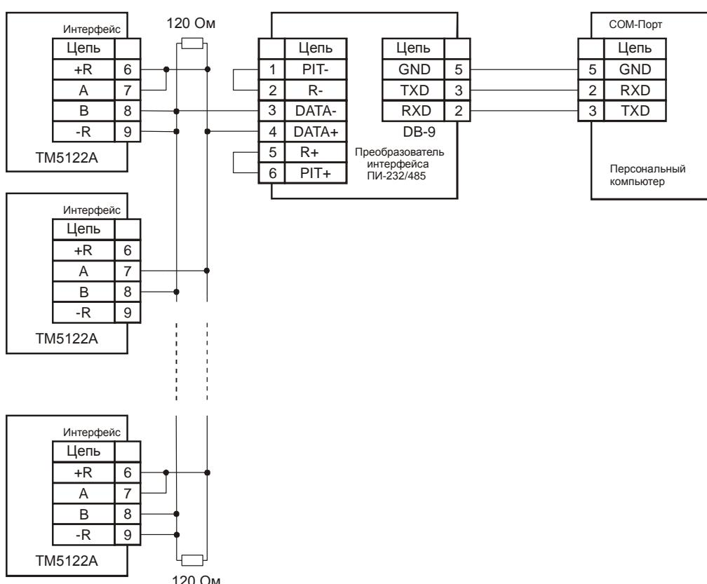
TM 5122A,... - измерительные приборы с интерфейсом RS 485.
