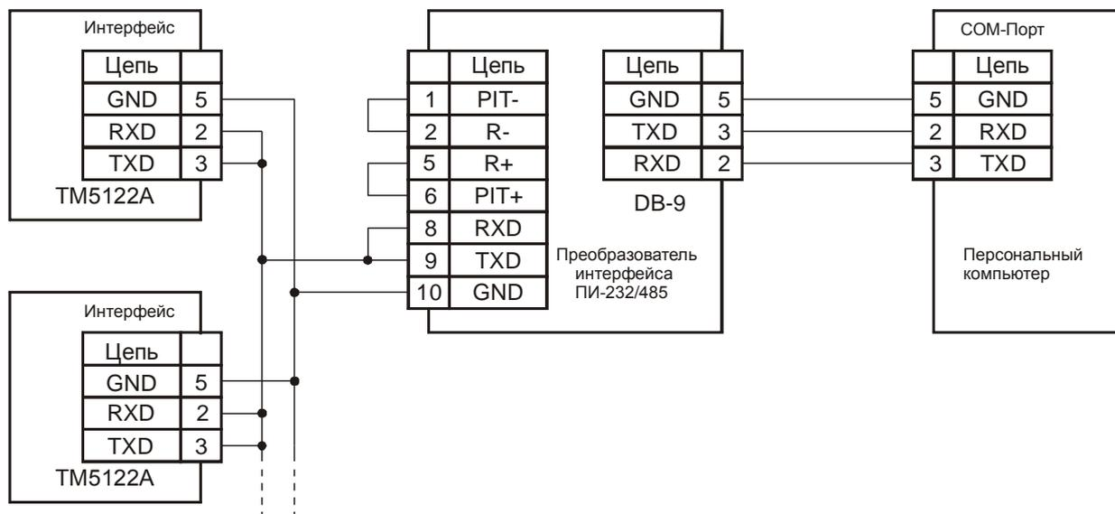
\* В качестве усилителя интерфейса RS 232 можно использовать ПИ 232/485 производства НПП «ЭЛЕМЕР»
